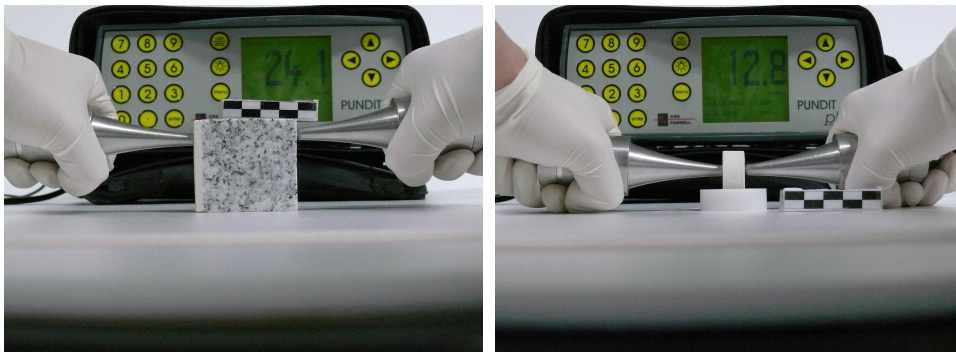
<그림 5> 시료의 초음파 전달시간 측정
