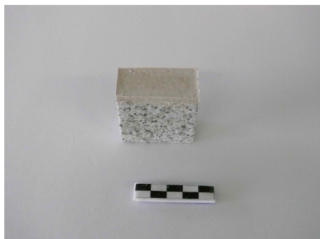
<그림 3> 무기질바인더를 적용한 암석시료
