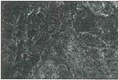
<그림 41> 녹제거 내후성 시험 전 실체현미경 사진
