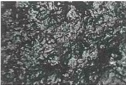
<그림 55> NAD-10 내후성 시험 전 실체현미경 사진
