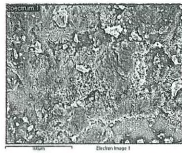
<그림 84> B-72 내후성 시험 후 SEM 사진
