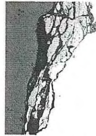
<그림 101> MC 일반형 내후성 시험 후 금속현미경 사진
