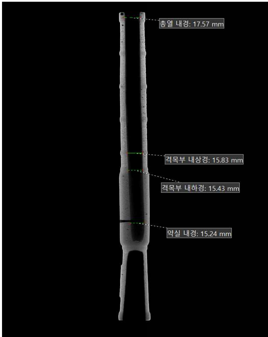
<사진 16> 63-삼총통의 컴퓨터단층촬영 종단면상 - 출처: 국립진주박물관 CT를 통해 내부구조를 살펴 본 결과 모든 총통의 총구입구부터 약실 저벽까지 내경
