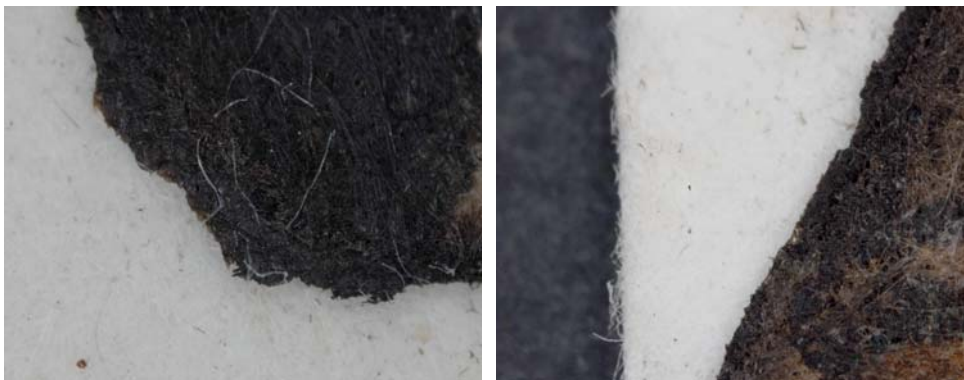
<그림 33> 부분충전처리, 표지 - 처리 후 현미경 관찰
