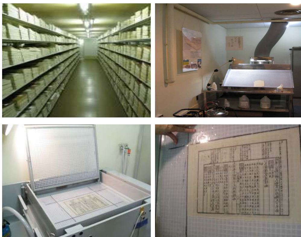
<그림 10> 일본 국립공문서관 서고, 탈산처리실, Leaf-casting 기기
