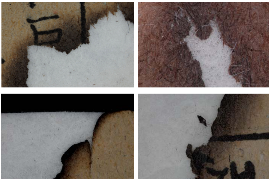
<그림 50> 펄프지, 화재 손상 - 처리 후 현미경 관찰
