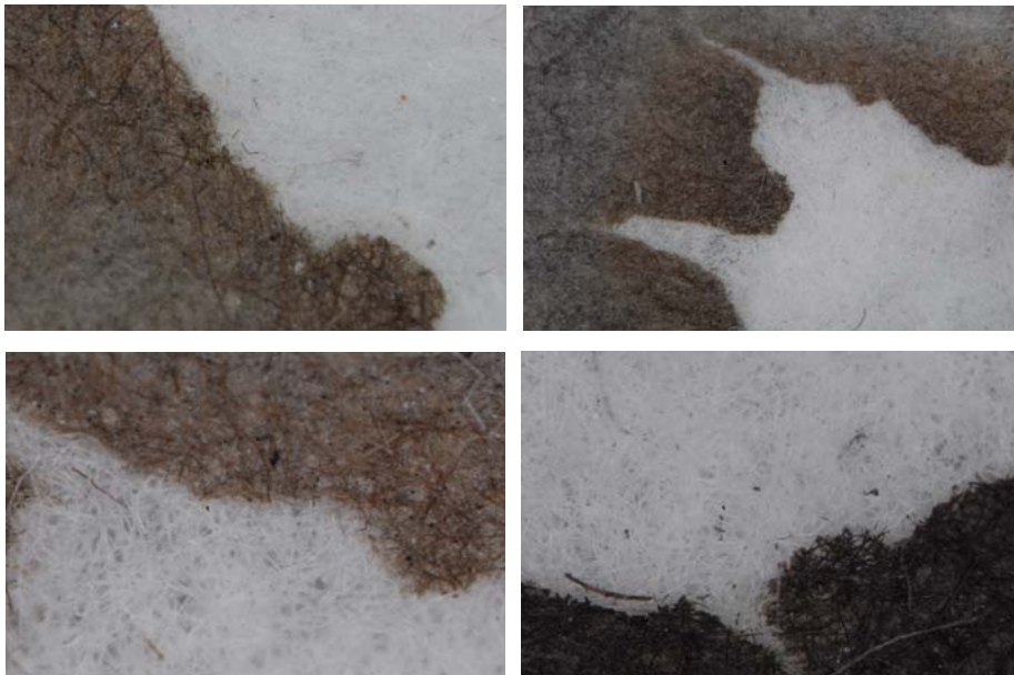
<그림 47> 화선지, 화재 손상 - 처리 후 현미경 관찰
