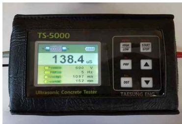
<그림 4> 초음파속도 측정기와 직접법에 의한 측정.
