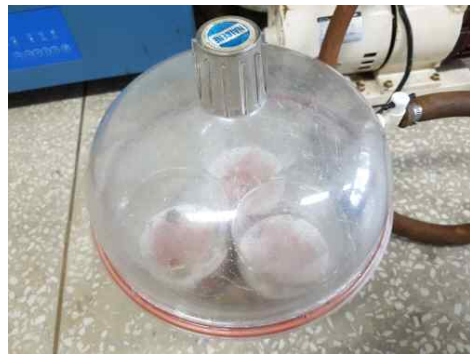
<그림 18> 강화제에 침적한 구 벽돌(좌)과 진공함침 과정(우).
