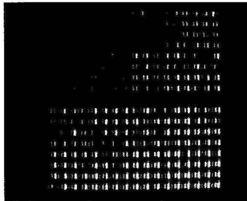
그림 27. 16계조 구현 Fig. 27. The realization of 16 gray scale
