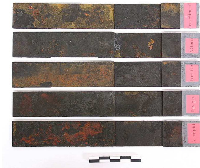
〈그림18〉 부식시킨 인장전단접착강도 시험편
