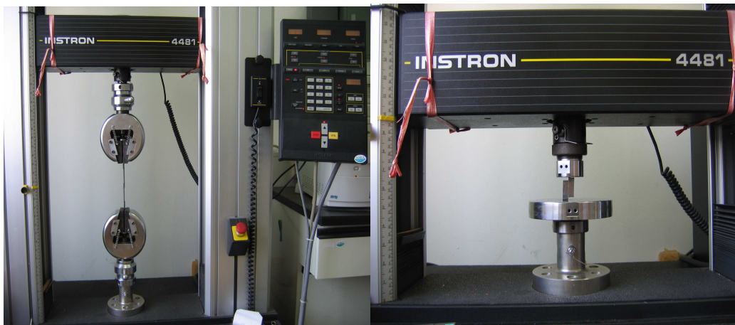
〈그림15〉 만능측정시험기(Instron 4481, Italy)
