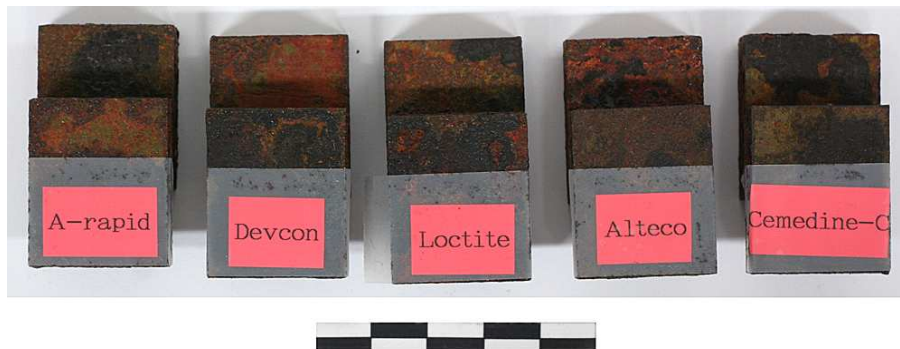
〈그림19〉 부식시킨 압축전단접착강도 시험편
